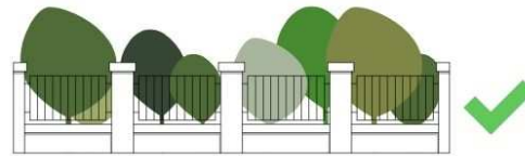
Oszlopos kerítés 1/3-ad lábazzal és 2/3-as áttört résszel
